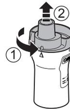
3. Quite el cabezal vaporizador del depósito de medicación.
